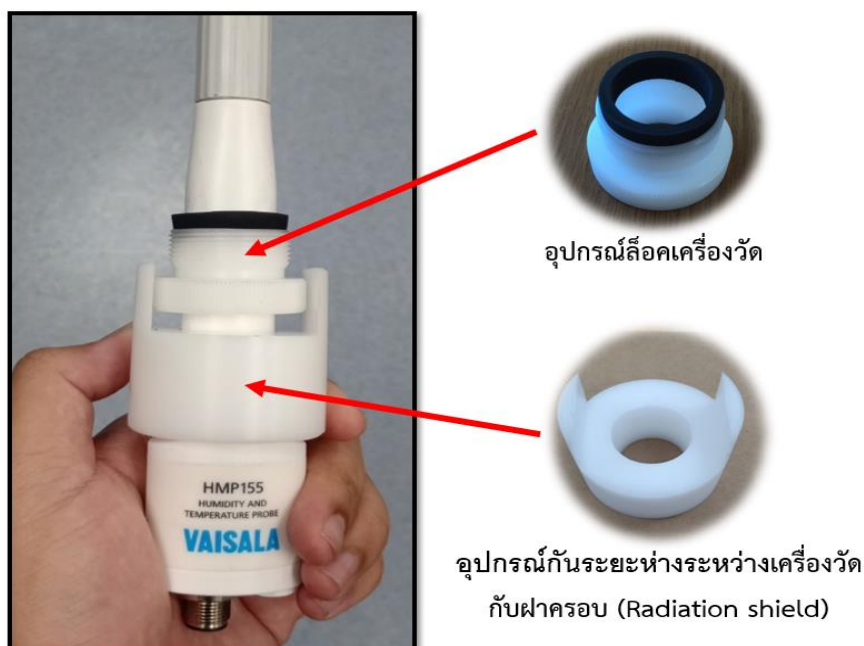
รูปที่ ๓๕ อุปกรณ์ล็อคเครื่องวัด และอุปกรณ์กันระยะห่าง ที่สวมเข้าไปที่เครื่องวัดอุณหภูมิและความชื้นสัมพัทธ์
