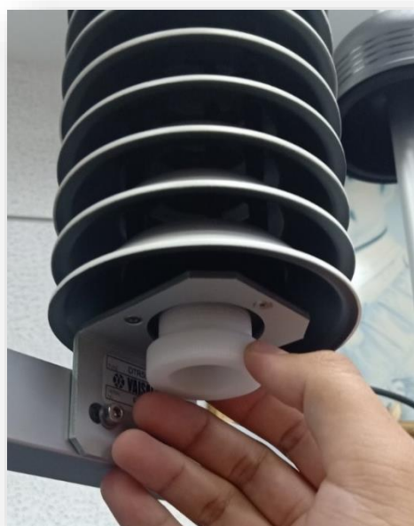
รูปที่ ๓๔ ตัวล็อคเครื่องวัดที่ติดอยู่กับอุปกรณ์ป้องกันรังสีจากดวงอาทิตย์
