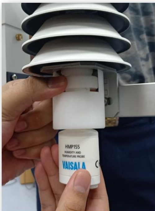
รูปที่ ๓๗ การติดตั้งเครื่องวัดกับอุปกรณ์ป้องกันรังสีจากดวงอาทิตย์
