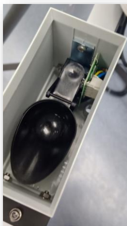
รูปที่ ๘ ด้านในของเครื่องวัดปริมาณน้ำฝน
