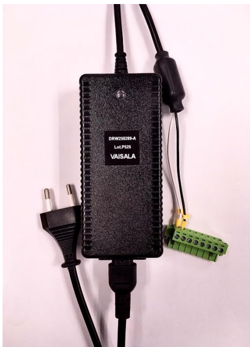
รูปที่ ๑๘ หม้อแปลงไฟฟ้าสำหรับ MOXA
