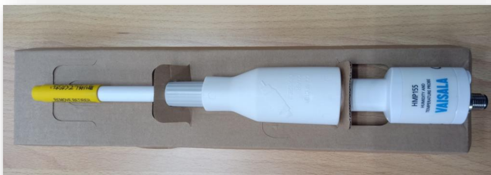
รูปที่ ๙ เครื่องวัดอุณหภูมิ และความชื้นสัมพัทธ์ (HMP155)
