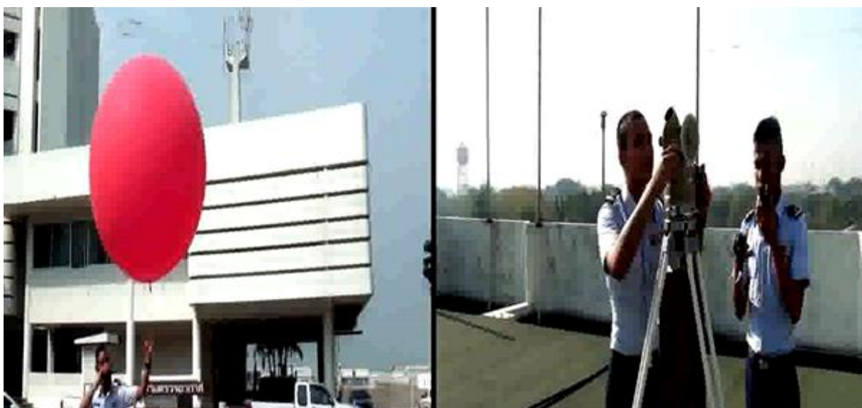
การตรวจอากาศชั้นบน แบบ “ PIBAL ”
