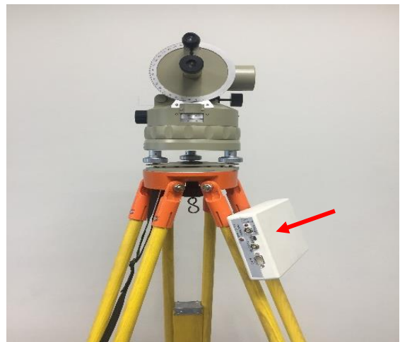
นำกล้องอินเทอร์เฟสมาติดตั้งเข้ากับขากล้อง
