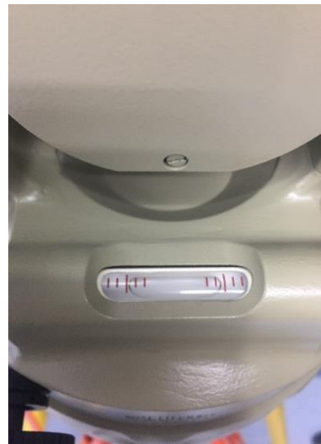
สังเกตสเกลระดับน้ำที่ตัวกล้องซึ่งจะต้องหมุนตัวปรับระดับน้ำที่ฐานเพื่อให้ระดับน้ำอยู่ตรงกลางสเกล
