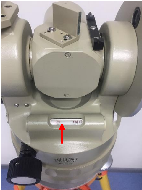
สังเกตสเกลระดับน้ำที่ตัวกล้องซึ่งจะต้องหมุนตัวปรับระดับน้ำที่ฐานเพื่อให้ระดับน้ำอยู่ตรงกลางสเกล
