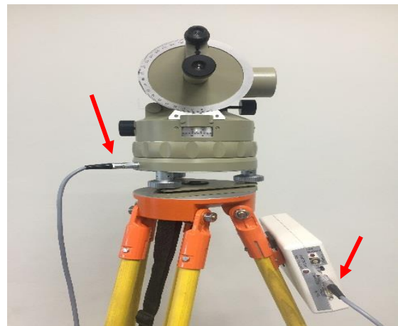
กล้องอินเทอร์เฟส และสายเชื่อมต่อระหว่างกล้องอินเทอร์เฟสกับตัวกล้อง (สายสีเทา)
