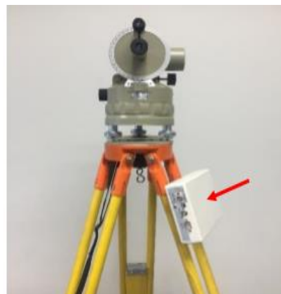
นำกล่องอินเทอร์เฟซมาติดตั้งเข้ากับขากล้อง
