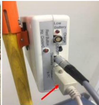
กล่องอินเทอร์เฟซ และสายเชื่อมต่อระหว่างกล่องอินเทอร์เฟซกับตัวกล้อง (สายสีเทา)
