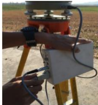
กล่องอินเทอร์เฟซ และสายเชื่อมต่อระหว่างกล่องอินเทอร์เฟซกับตัวกล้อง (สายสีเทา)
