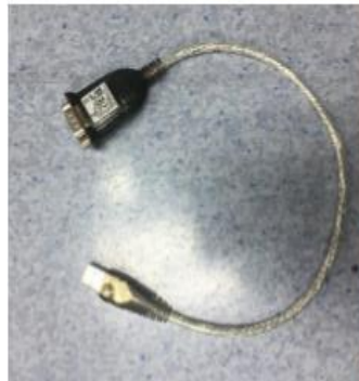
สายเชื่อมต่อระหว่างกล่องอินเทอร์เฟซกับคอมพิวเตอร์ (สายสีขาว) และสายแปลงที่ต่อเข้ากับคอมพิวเตอร์
