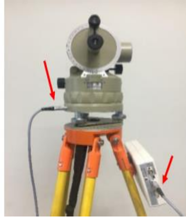
กล่องอินเทอร์เฟซ และสายเชื่อมต่อระหว่างกล่องอินเทอร์เฟซกับตัวกล้อง (สายสีเทา)
