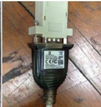
สายเชื่อมต่อระหว่างกล่องอินเทอร์เฟซกับคอมพิวเตอร์ (สายสีขาว) และสายแปลงที่ต่อเข้ากับคอมพิวเตอร์
